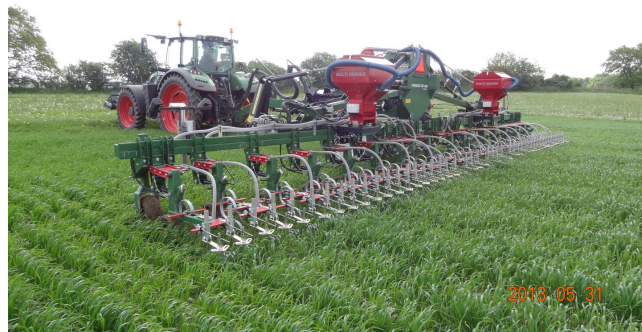
Kamerastyret radrenserer med arbejdsbredde på 12 m. (Klik på billedet for stor udgave)
